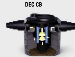
By-pass delle portate eccedenti la portata nominale A Deoliatore B Dissabbiatura C Deoliatore D Sifone uscita acqua depurata in out Ø 600 ÷ Ø 800
